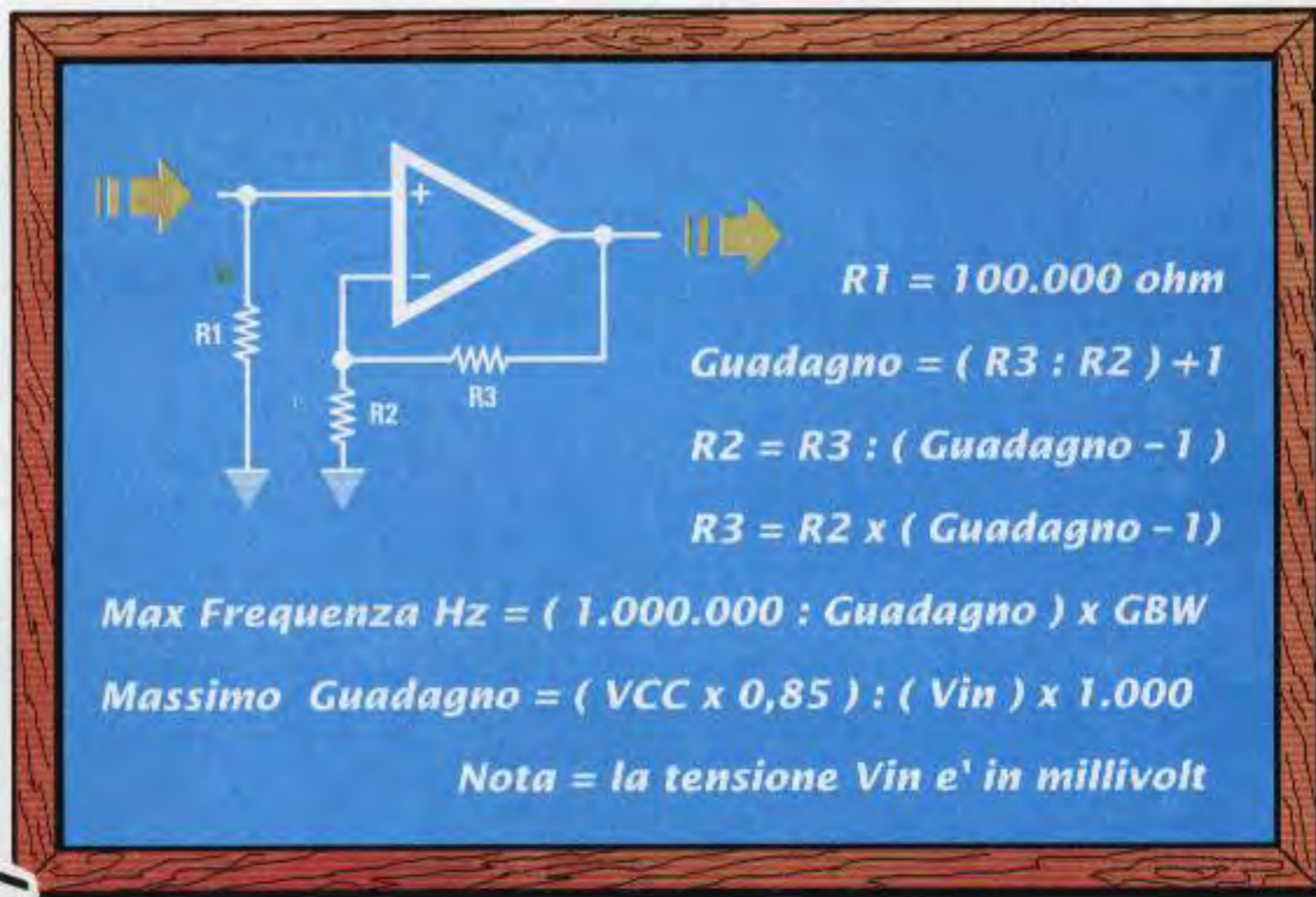
Fig.106 Schema e formule di un amplificatore che utilizza l'ingresso NON INVERTENTE.
