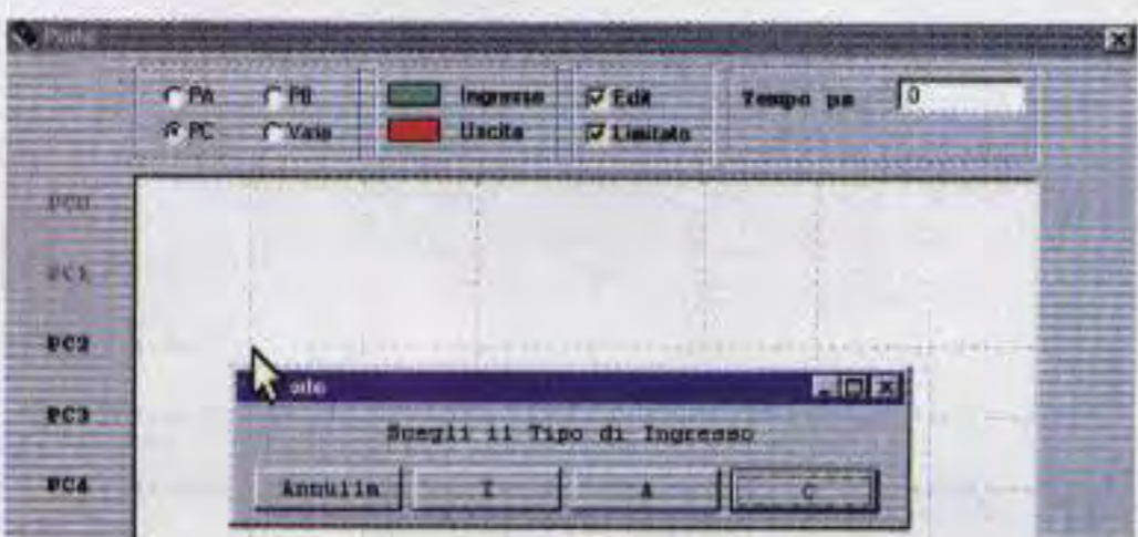
Fig.18 Cliccando su PC2 si attiva la maschera per selezionare il tipo di segnale in ingresso. Per selezionare un segnale ciclico utilizzate il pulsante con la lettera C.
