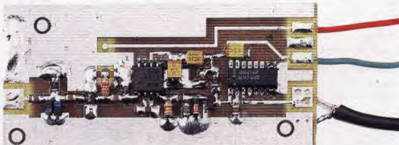
Fig.8 Foto del prescaler in SMD, visto dal lato dei componenti, che vi forniremo già montato.
