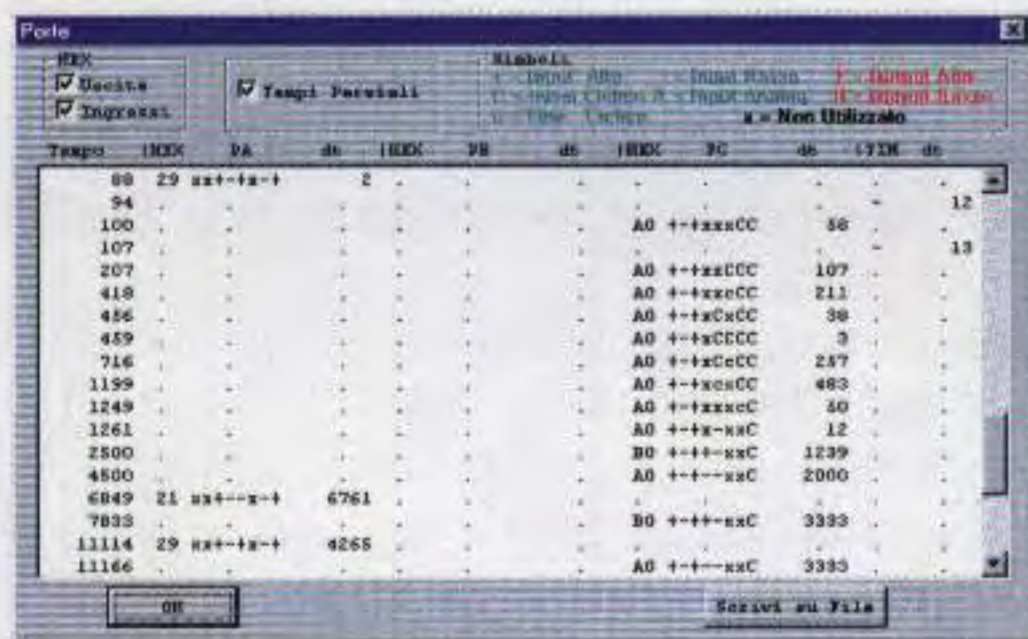
Fig.24 In questa figura potete vedere un esempio di visualizzazione numerica dei segnali immessi o rilevati sui piedini del micro durante la simulazione.
