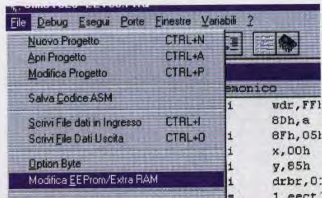
Fig.2 Per modificare la memoria Eeprom o la Ram aggiuntiva, scegliete dal menu File il comando Modifica EEPROM/Extra RAM.
